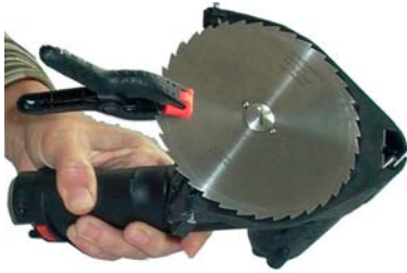
الصورة رقم 21: مسك وتثبيت الشفرة الدائرية بالكمامشة الخاصة بها.
