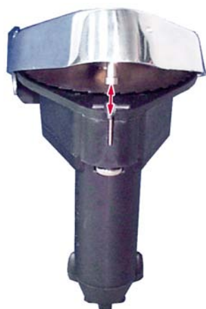
Fig. 22 Déblocage de l'enveloppe de protection
