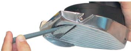
Fig. 43 Apposer la pierre d'affûtage sur la partie inférieure du disque trancheur
