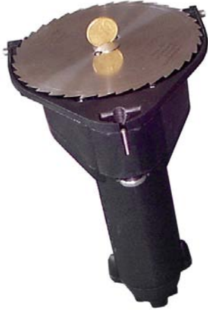
Fig. 26 Vis du disque avec pièce de monnaie insérée
