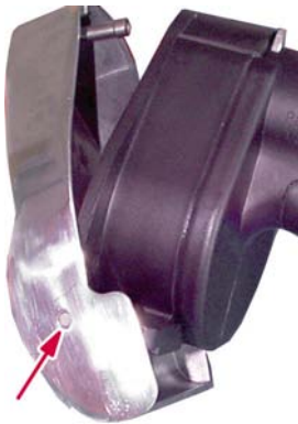
Fig. 33 Installation de l'enveloppe de protection (B)
