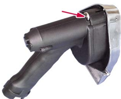
Fig. 21 Molette pour débloquer l'enveloppe de protection
