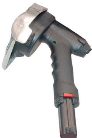
Fig. 10 Insérer le bloc batterie
