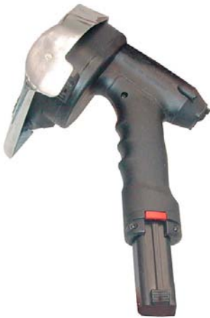
Fig. 20 Retirer le bloc batterie
