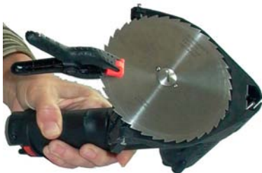
Fig. 28 Disque trancheur fixé par une pince-étau
